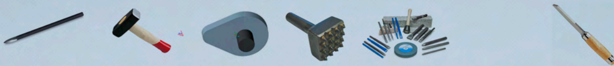
1. PUNTERO ; 2. MANDARRIA ; 3. LEVA ; 4. BUJARDA ; 5. ESCODA ; 6. MARRÓN ; 7. ESCOPLA
